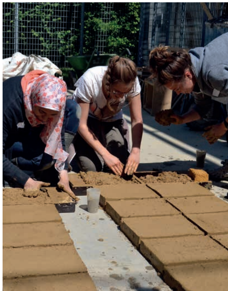
Lehm ist ein Material, das alle Menschen auf dem Globus verbindet – Fertigung der luftgetrockneten Lehmziegel für eine Sichtschutzmauer auf dem Gelände
